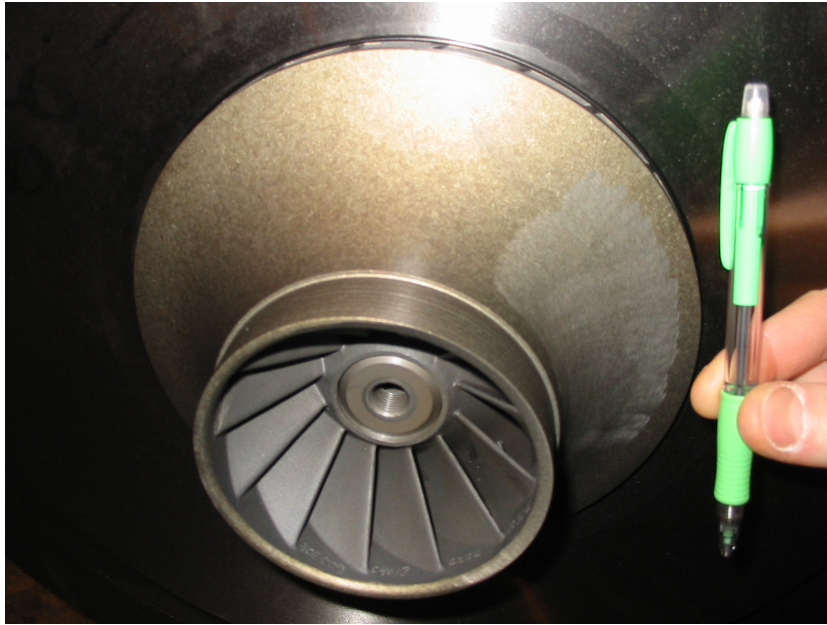
Figura 2.10: Una girante di compressore centrifugo per macchina frigorifera con HFC134a: potenza frigorifera 4100 kW, 16000 -18000 giri al minuto.
