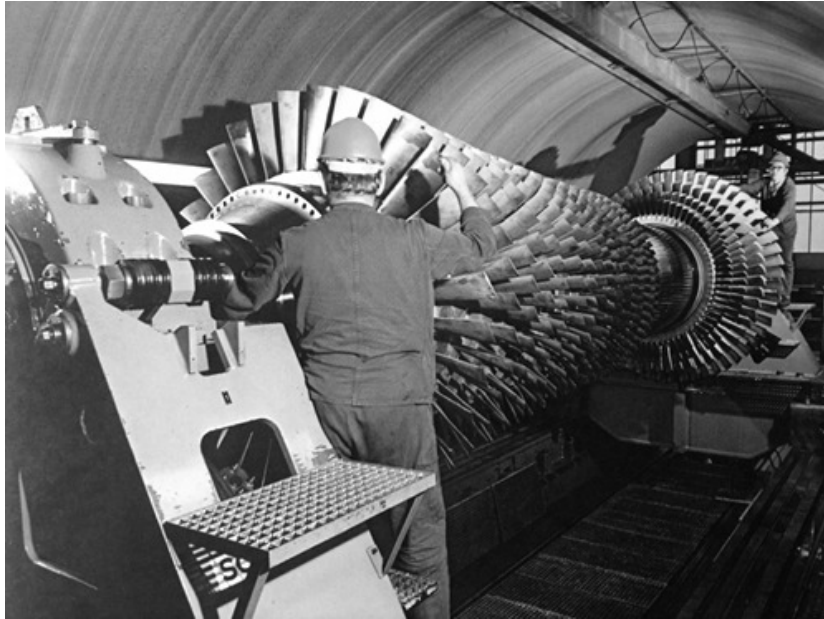
Figura 2.12: In primo piano un esempio di compressore assiale multistadio, [12].
